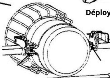
Installer le moteur et serrer les boulons de fixation du moteur (4x)
