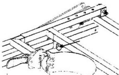
Replier le support de moteur et les bras de support, utiliser une goupille pour les maintenir en place
