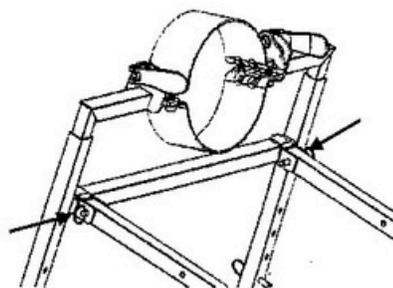
Déplier vers le haut le support du moteur et les bras de support et réinsérer les goupilles (2x)
